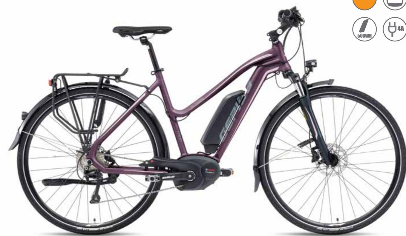
△ FRAME GEPIDA SPECIAL HYDROFORMING - 6061 ALLOY
